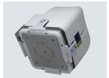
Al agarrar la oblea desde arriba, se utiliza una combinación de presión negativa y ultrasonido. La presión negativa asegura la atracción de la oblea, mientras que el ultrasonido con su efecto repulsivo mantiene la pieza a distancia. Por lo tanto, no hay puntos de contacto entre la oblea solar y la pinza, por lo que se garantiza un manejo suave.
